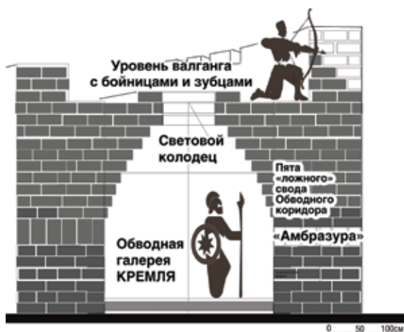
Рис. 6. Реконструкция ложного свода обводной галереи кремля
