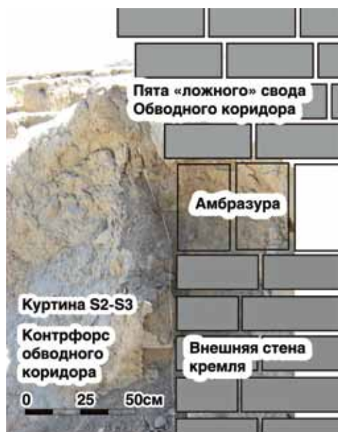
Рис. 5. Схема построения ложных сводов кремля на основе сохранившегося фрагмента
